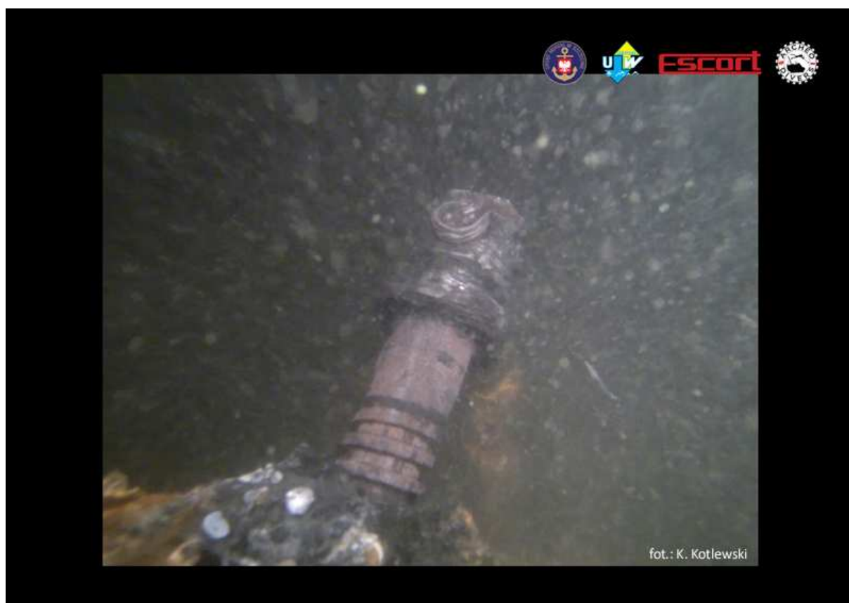
Ryc.12. Korba z uchwytem imadła na pokładzie. Zdjęcie wykonane przez nurka.
